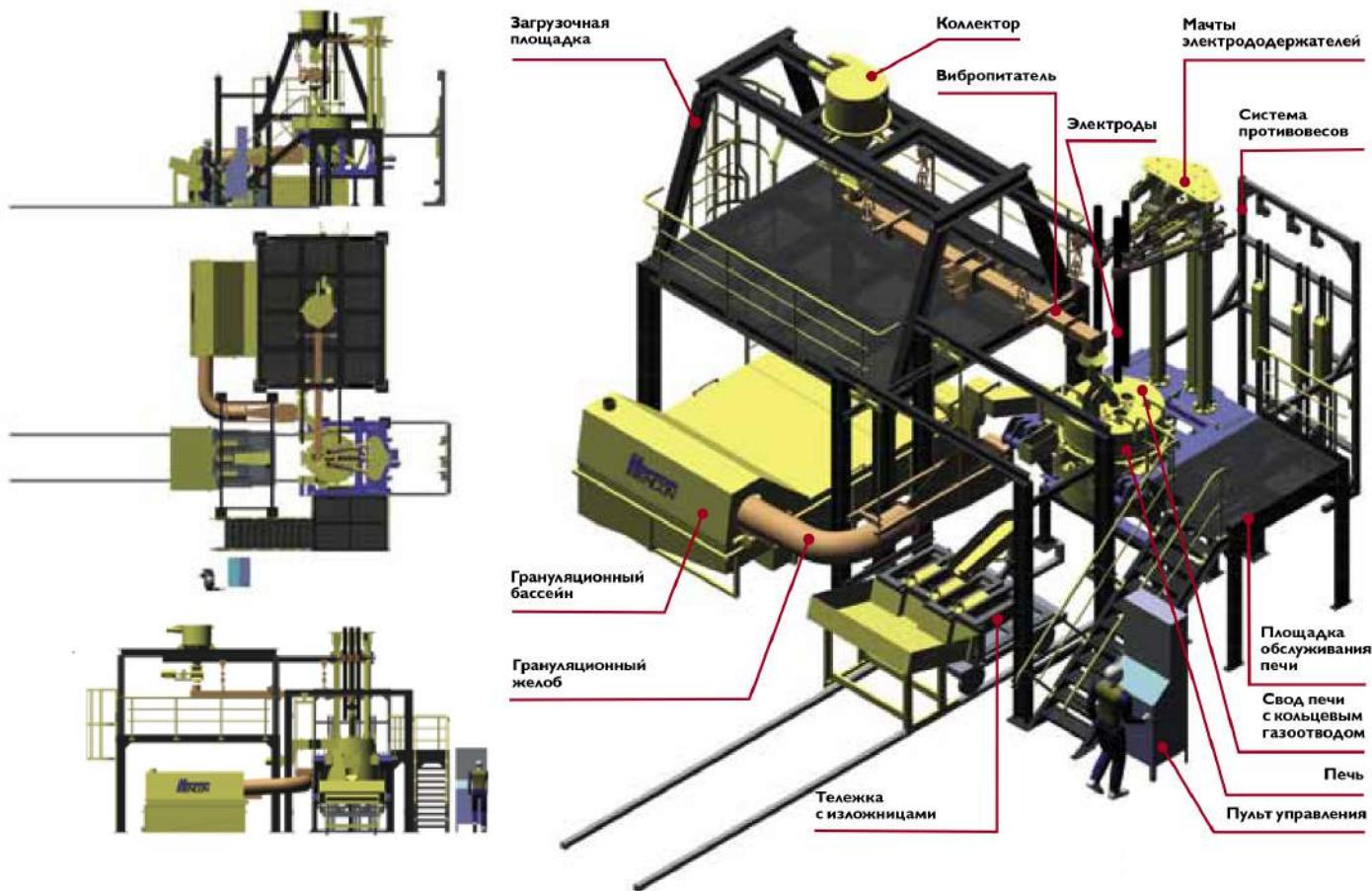
Честь примера реализации уникальных проектов можно привести печь постоянного тока, изготовленную для компании Xstrata plc. Печь мощностью 7,5 МВА с максимальной загрузкой 22 тонны применяется для получения феррованадия при температурах выше 2000 °C. Это первая в мире печь постоянного тока для производства феррованадия.
